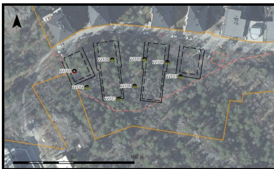
Figur 16 Streckade linjer visar ytor för planerade byggnader. Placering utförda provtagningspunkter med klassning enligt Naturvårdsverkets generella riktvärden, gult visar halter över KM, men lägre än MKM och rött halter över FA.
